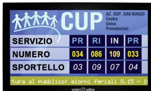
Il display è realizzato con tecnologia TFT ed ha una dimensione di 40" che risulta ben visibile. Le caratteristiche di elevata luminosità e ampio angolo di lettura permettono poi una leggibilità delle informazioni da una vasta area e da lunga distanza.
